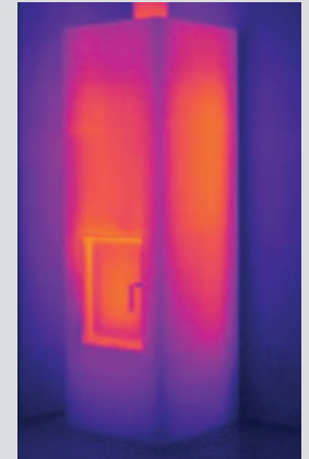
12 hod. od zatopení Průměrná teplota povrchu 45 °C
